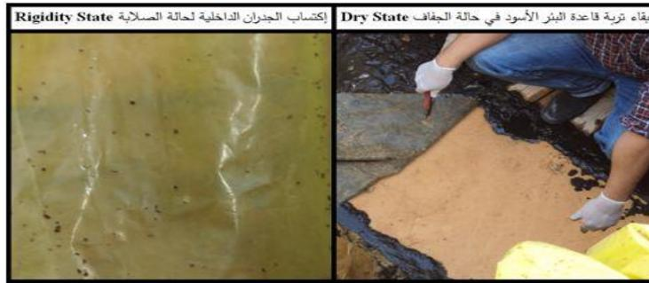
الشكل 5: الفحص العيني لأداء الغشاء الجيوبلاستيكي في بئر التجربة بعد تفريغ عبوة المياه السوداء .
