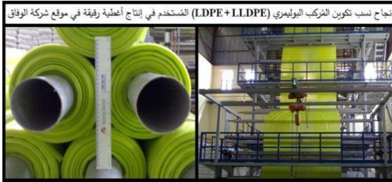
الشكل 6: خط إنتاج شركة الوفاق في جنزور لرقائق أغطية بلاستيكية بسمك  $\delta = 200$   $\mu\text{m}$  [19].
